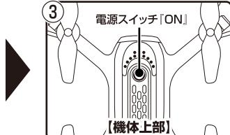
③機体の電源スイッチを押して「ON」にします。機体後部の緑LEDが点滅します。
