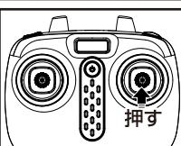
スピードは送信機の「スピード切替スイッチ」で2段階の切替が可能です。
