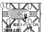
①機体の電源スイッチを「ON」にして、平らな場所に置きます。
