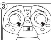
③ペアリング後、左右の両方のステイックをそれぞれ右下45度の角度に2~3秒倒します。機体のLEDが早い点滅から点灯になるとリセット完了です。
